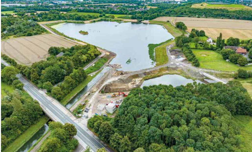
Das Hochwasserrückhaltebecken Dortmund-Ellinghausen im gefüllten Zustand – hier wird der Nutzen der Anlage für die Bevölkerung deutlich: Das Becken hält Wassermassen zurück, die sonst unter Umständen zu Überflutungen führen könnten.
