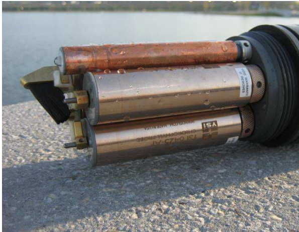
Abbildung 6.1: Sensoren der Multiparametersonde
