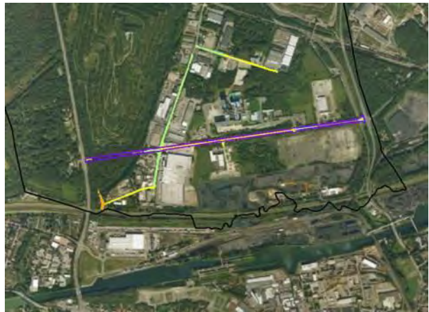
MOT 2.1 Straßenzustand Handlungsbedarf ■ 3 Deckenbelagererneuerung ■ 4 Erneuerung mit teilweiser Verstärkung ■ 5 Erneuerung Oberbau und Unterbau
