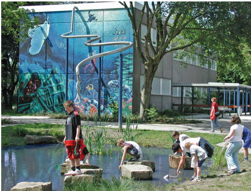
Abbildung 94: Die mit Dachabflüssen gespeiste Wasserfläche ist attraktiver Anziehungspunkt auf dem Schulhof (eigene Abb.)
