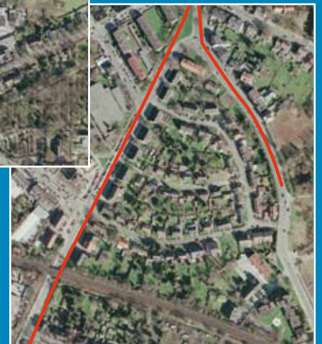
Verlauf des zukünftigen Abwasserkanals
